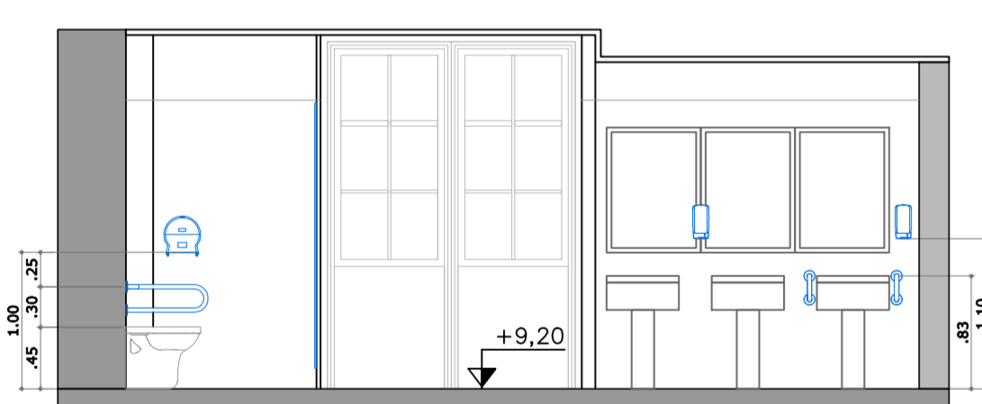
1 VISTA 3º PAVIMENTO - SANITÁRIO MASCULINO ESC 1:50
