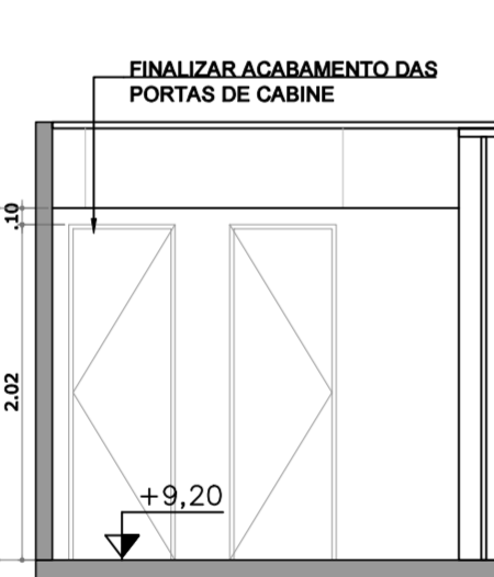
② VISTA 3º PAVIMENTO – SANITÁRIO MASCULINO ESC 1:50
