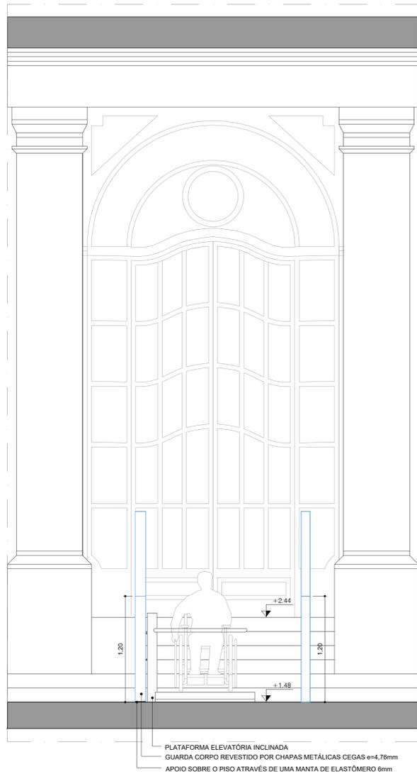
**A** CORTE PLATAFORMA ELEVATÓRIA INCLINADA
