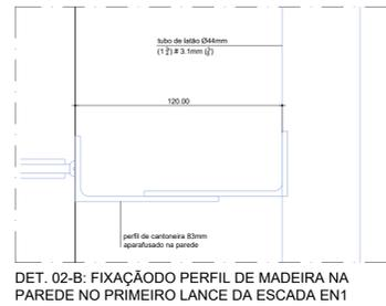
DET.02: FIXAÇÃO DO PERFIL DE MADEIRA NA PAREDE NO PRIMEIRO LANCE DA ESCADA EN1 PLANTA
