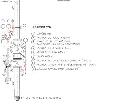
**ESQUEMA TIPO - VÁLVULA DE GOVERNO E ALARME INSTALADA NA TUBULAÇÃO DE REGALQUE DA BOMBA**
