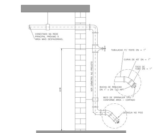
**RAMAL DE TESTE DA ÁREA MAIS DESFAVORÁVEL EXISTENTE NO 9º PAVIMENTO - COBERTURA SEM ESCALA**
