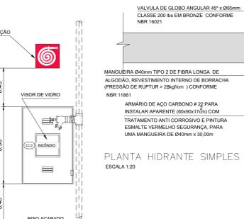
**HIDRANTE SIMPLES - SISTEMA TIPO 3 ELEVÇÃO EXTERNA**
